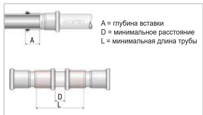
Рис. 27. Глубина вставки и минимальные размеры.
